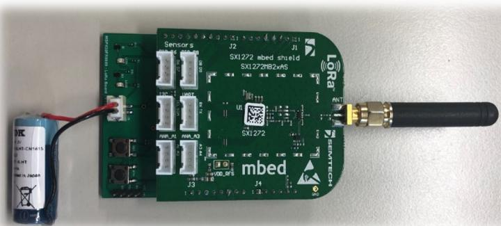
Prototype avec la nouvelle technologie de communication LoRa
