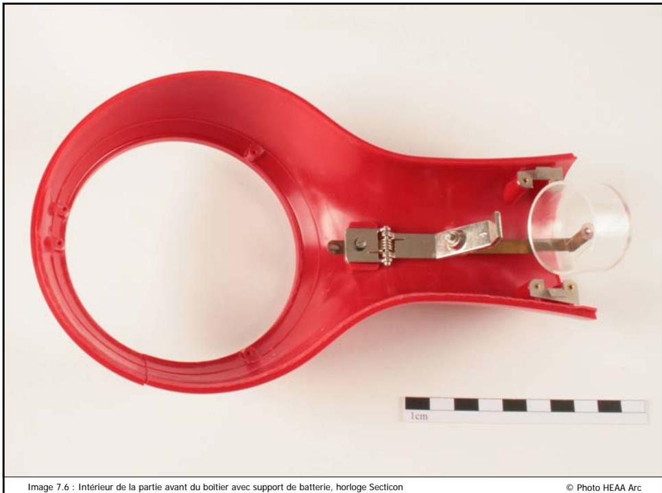
Image 7.6 : Intérieur de la partie avant du boîtier avec support de batterie, horloge Secticon
