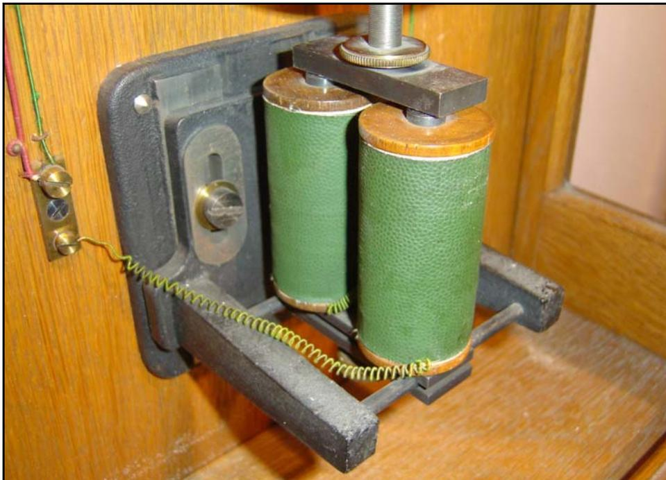
Image 8.1 : Détail de l'électro-aimant, horloge Favre
