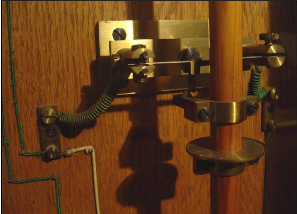
Image 8.1 : Détail du pendule avec contact électrique, horloge Favre
