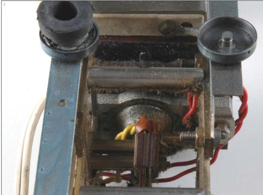
Image 1.50 : Détail du moteur et interrupteur de la sonnerie des quarts, mouvement de base
