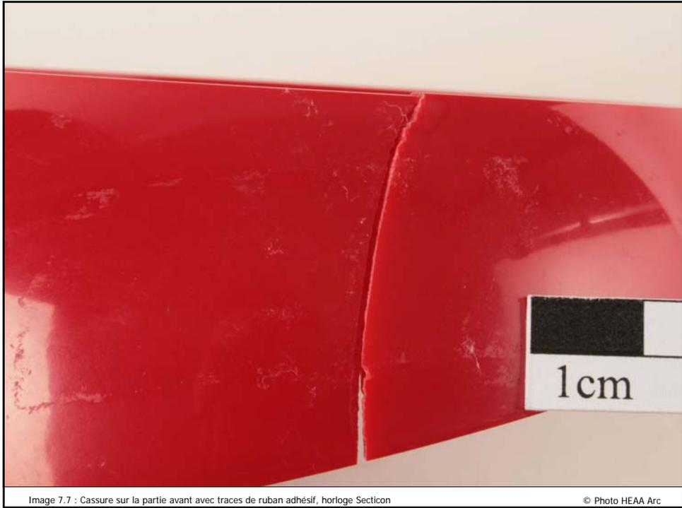
Image 7.7 : Cassure sur la partie avant avec traces de ruban adhésif, horloge Secticon
