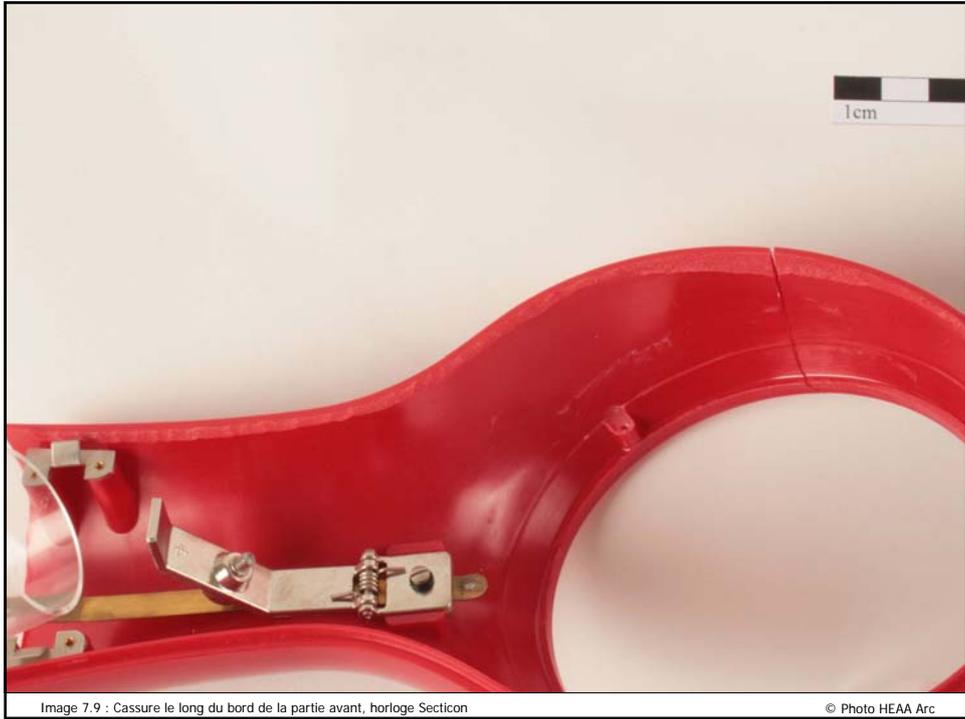
Image 7.9 : Cassure le long du bord de la partie avant, horloge Secticon
