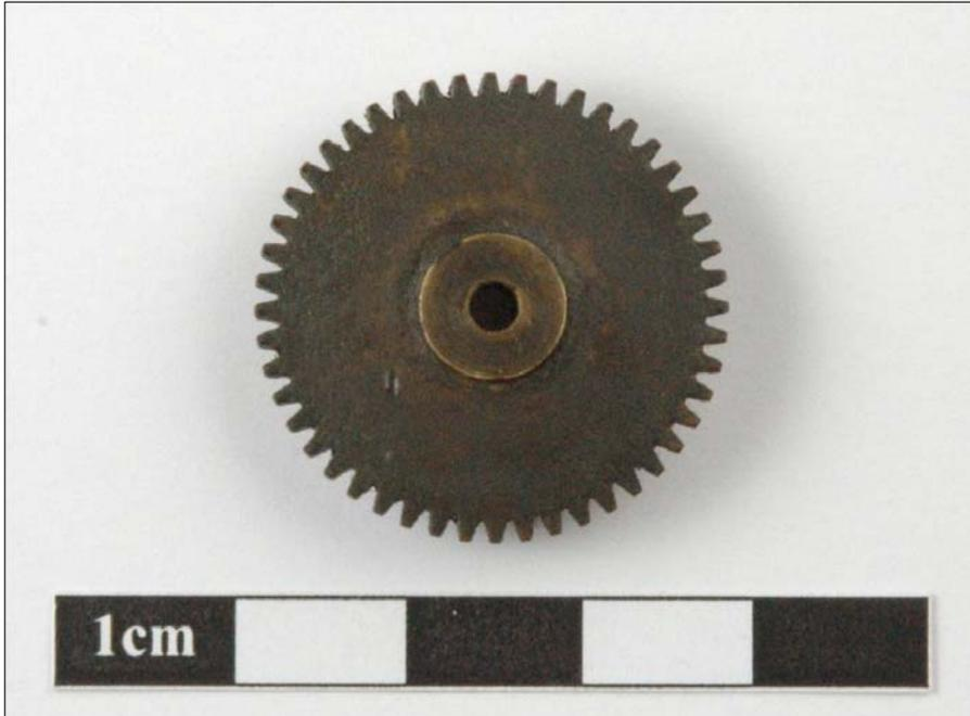
Image 1.16 : Roue de transmission (verso), mouvement calendrier
