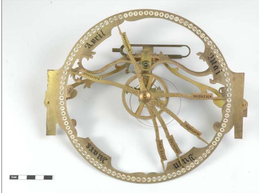
Image 1.61 : Mécanisme de fêtes mobiles, mouvement calendrier
