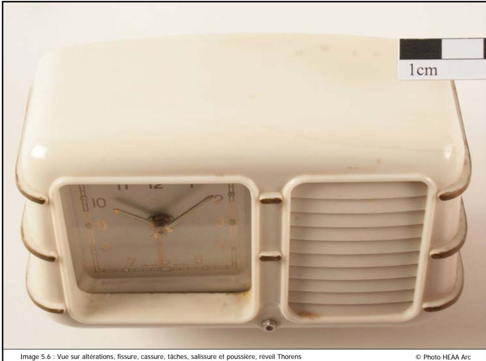
Image 5.6 : Vue sur altérations, fissure, cassure, tâches, salissure et poussière, réveil Thorens
