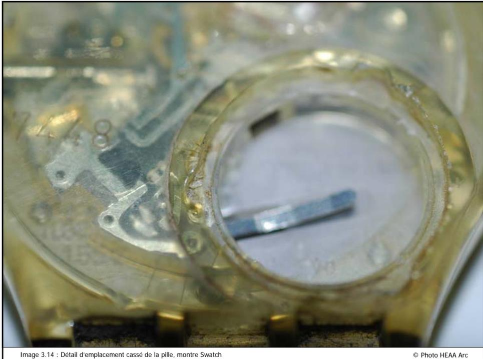
Image 3.14 : Détail d'emplacement cassé de la pile, montre Swatch
