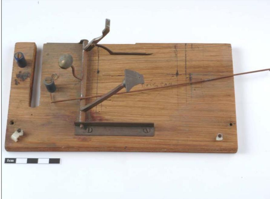
Image 1.47 : Mécanisme du contact de midi, mouvement de base
