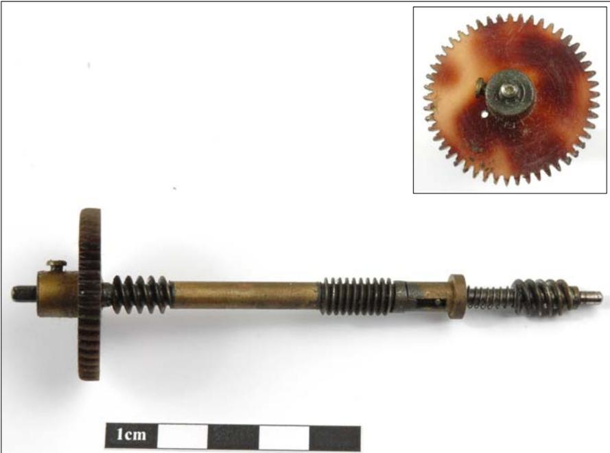
Image 1.28 : Roue de transmission, mouvement de base, et détail de la roue (en médaillon)
