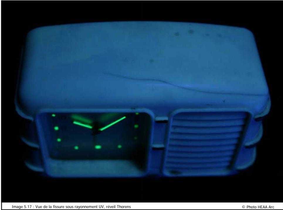
Image 5.17 : Vue de la fissure sous rayonnement UV, réveil Thorens
