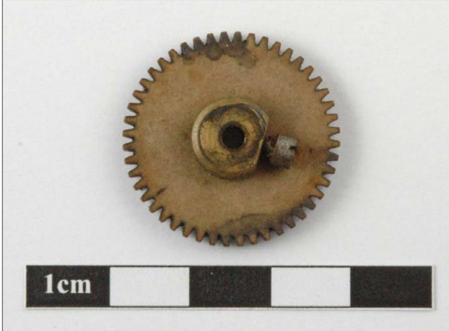
Image 1.15 : Roue de transmission, mouvement calendrier
