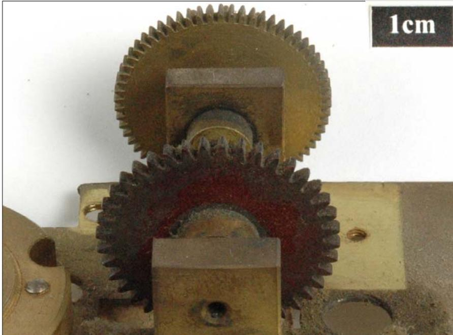
Image 1.18 : Détail du mécanisme d'entraînement, carillon
