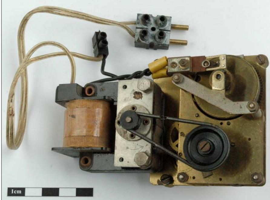
Image 1.9 : Prise, interrupteur et moteur électrique, mouvement astronomique
