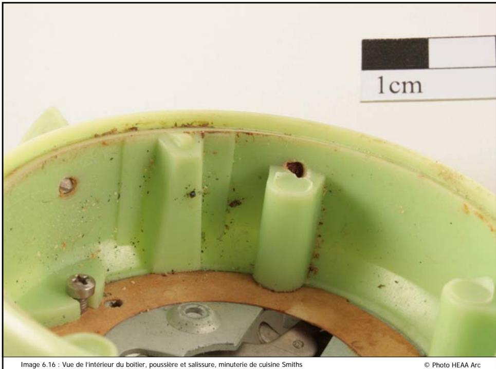
Image 6.16 : Vue de l'intérieur du boîtier, poussière et salissure, minuterie de cuisine Smiths
