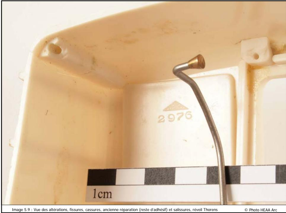
Image 5.9 : Vue des altérations, fissures, cassures, ancienne réparation (reste d'adhésif) et salissures, réveil Thorens
