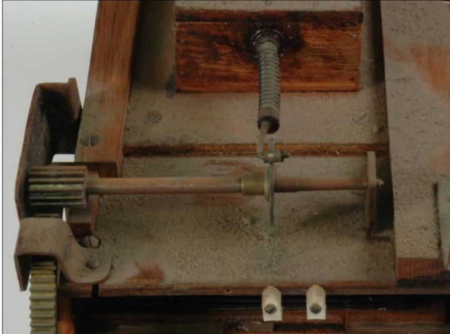
Image 1.60 : Détail du soufflet (gaine noire et fixation de câble), groupe automate
