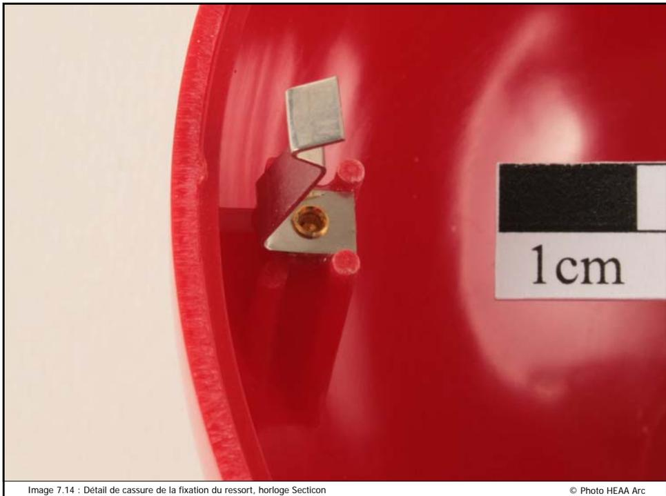
Image 7.14 : Détail de cassure de la fixation du ressort, horloge Secticon
