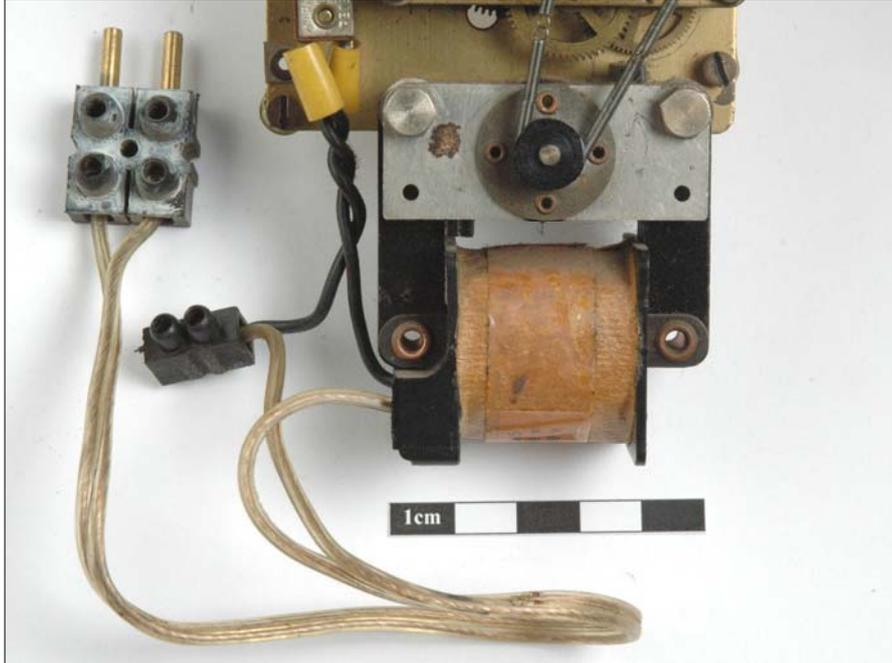
Image 1.11 : Prise et bobine du moteur, mouvement astronomique
