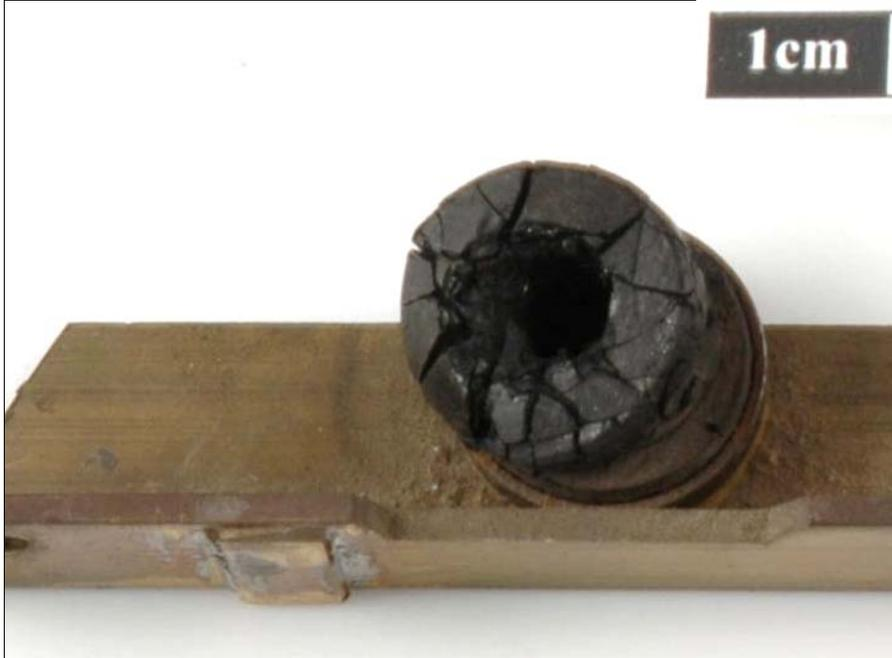
Image 1.52 : Détail d'un pied amortisseur du mécanisme de la sonnerie des quarts, mouvement de base
