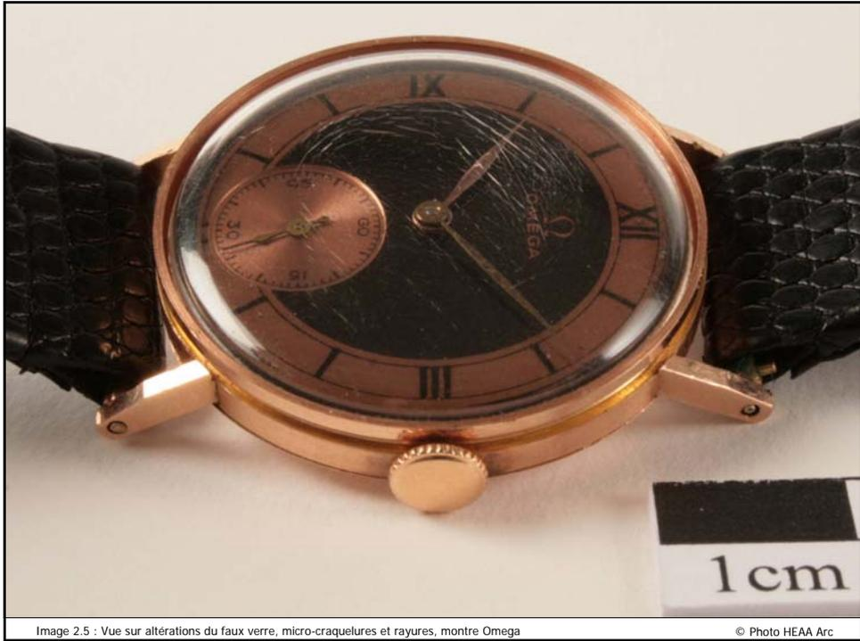
Image 2.5 : Vue sur altérations du faux verre, micro-craquelures et rayures, montre Omega
