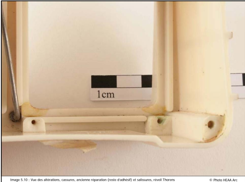
Image 5.10 : Vue des altérations, cassures, ancienne réparation (reste d'adhésif) et salissures, réveil Thorens
