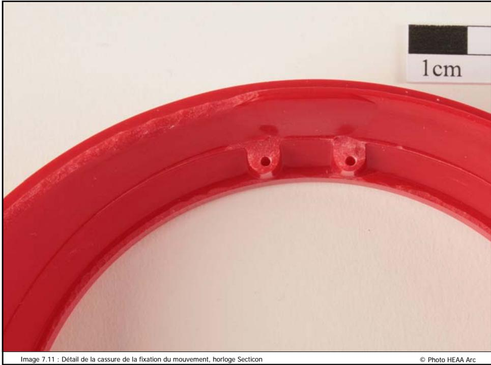
Image 7.11 : Détail de la cassure de la fixation du mouvement, horloge Secticon
