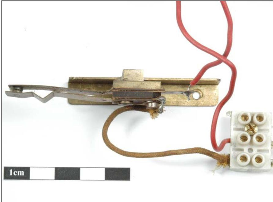
Image 1.4 : Interrupteur, mouvement astronomique
