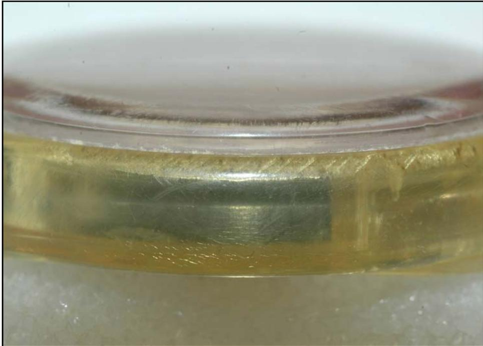
Image 3.11 : Détail de micro-craquelure, montre Swatch
