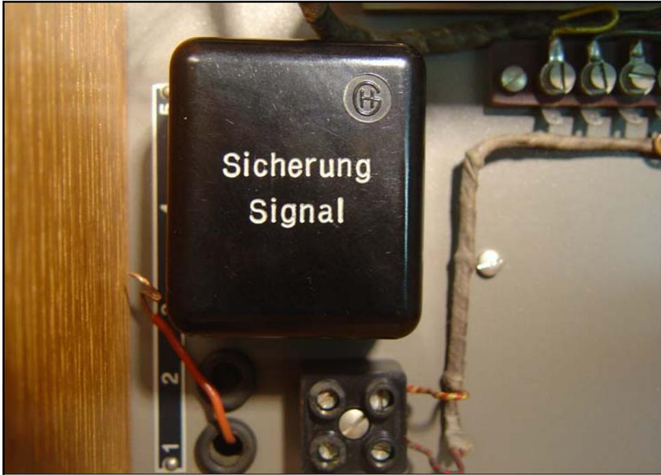
Image 10.3 : Détail de la boîte aux fusibles, horloge Favag
