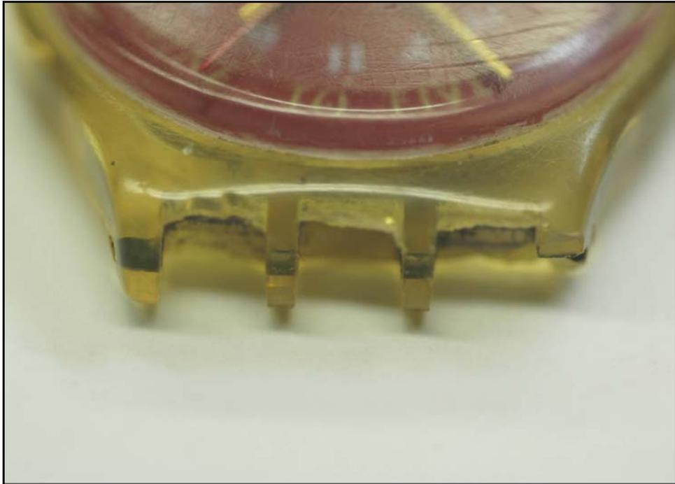
Image 3.9 : Détail de la fixation du bracelet cassée, montre Swatch
