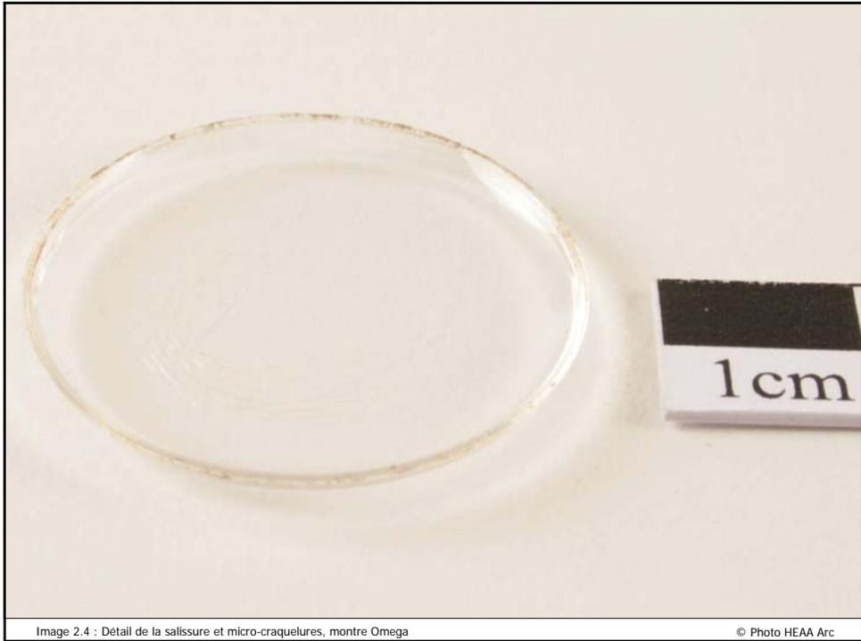
Image 2.4 : Détail de la salissure et micro-craquelures, montre Omega
