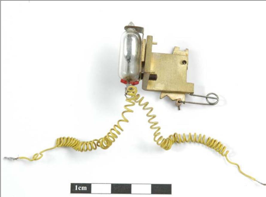
Image 1.27 : Interrupteur à mercure (remontoir), mouvement de base
