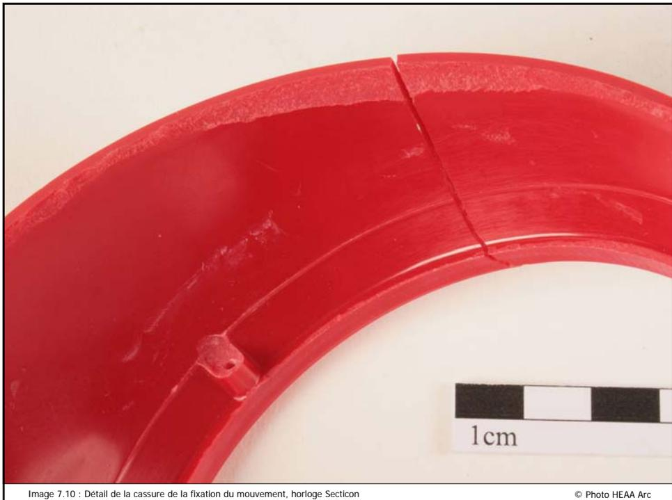
Image 7.10 : Détail de la cassure de la fixation du mouvement, horloge Secticon
