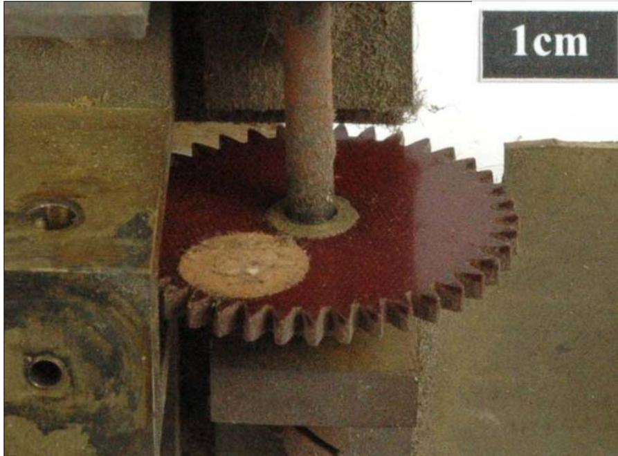
Image 1.22 : Détail du mécanisme d'entraînement, carillon
