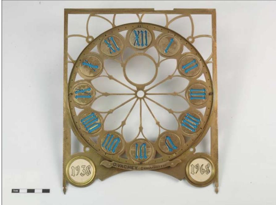
Image 1.62 : Cadran principal (heures et minutes), mouvement de base
