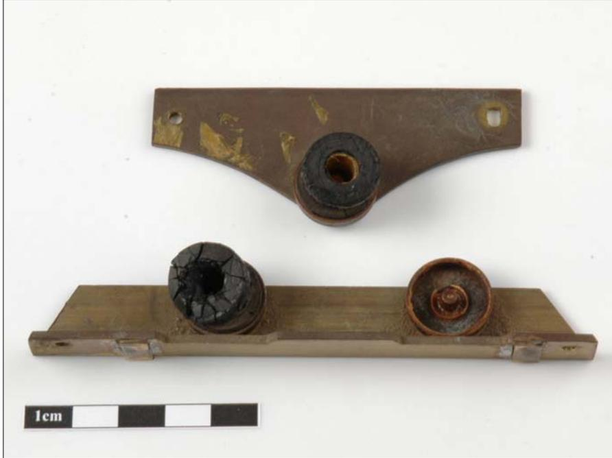
Image 1.51 : Pieds amortisseurs du mécanisme de la sonnerie des quarts, mouvement de base
