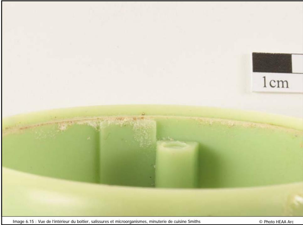
Image 6.15 : Vue de l'intérieur du boîtier, salissures et microorganismes, minuterie de cuisine Smiths
