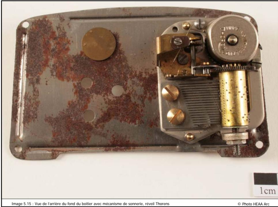
Image 5.15 : Vue de l'arrière du fond du boîtier avec mécanisme de sonnerie, réveil Thorens
