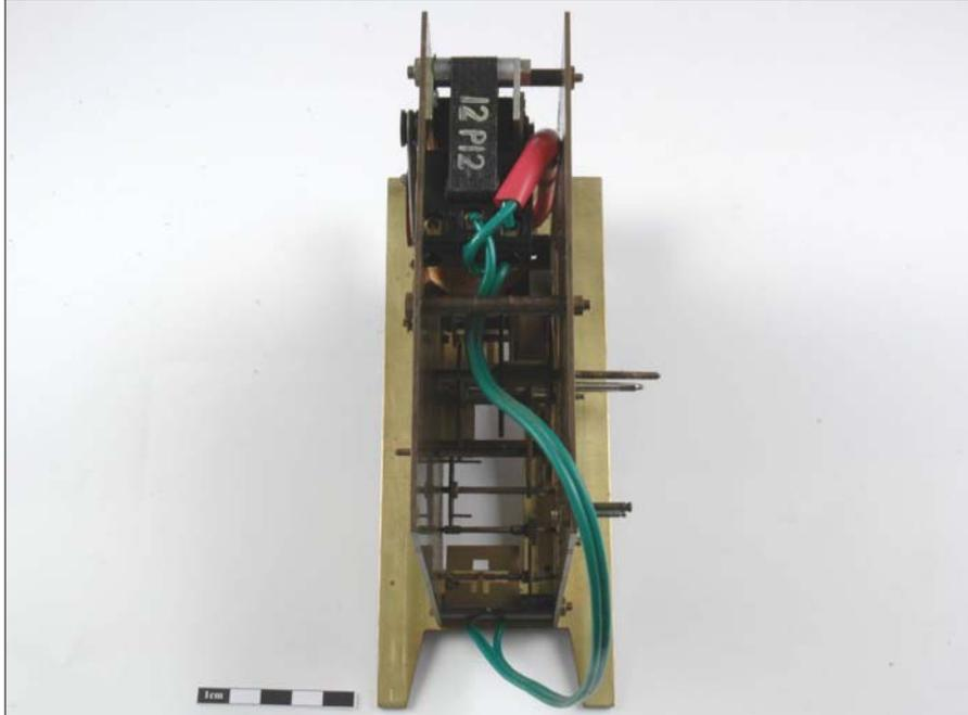
Image 1.55 : Détail du mécanisme de la sonnerie d'Angélus (moteur électrique), mouvement de base
