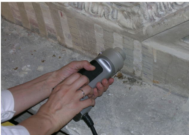
Fig. 1: Analisi non invasive: controllo con colorimetro Minolta Chroma Meter cr-200 nella Chiesa di San Francesco, Locarno.
