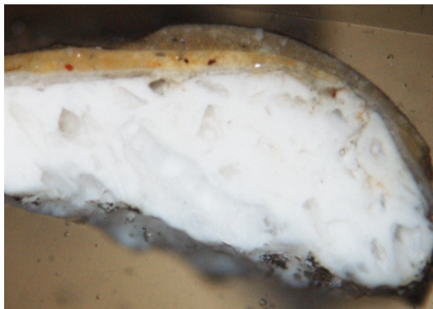
Fig. 2: Sezione lucida di un campione di stucco della Cappella del Rosario. Strato grigio: scialbatura da rimuovere. Strato giallo: colore da preservare.
