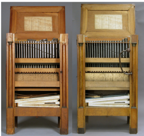
Fig. 1 : Photo de l'orgue avant et après traitement dimensions (L x l x h) = 595 mm x 405 mm x 936 mm © Valérie Seematter
