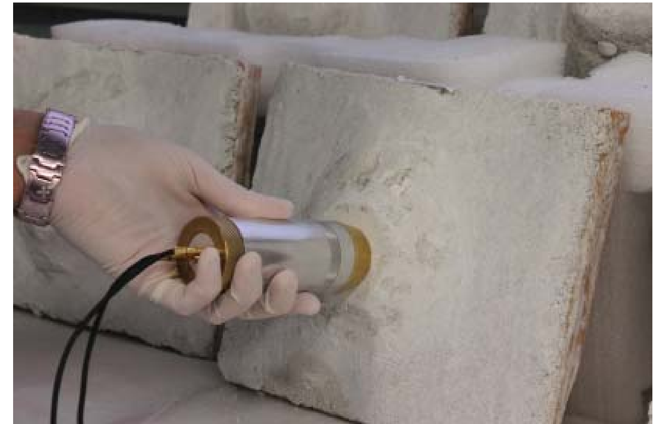
Fig. 3: Measure of moisture content and salinity index on a replica with SUSI (Sensore di umidità e salinità integrato, IFAC-ICVBV, CNR, Florence).
