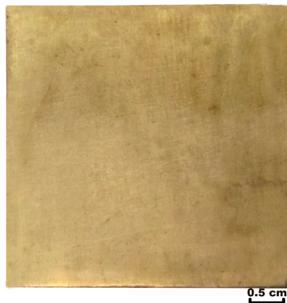
Fig. 2: Echantillon avec dorure par remplacement électrochimique avant la création des produits de corrosion en surface.
