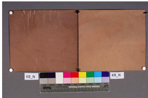
Optische Veränderung Versuchsreihe 4: Lederprobe, die mit dem am stärksten gepufferten Papier in Kontakt war (KB_N) im Vergleich zur Referenzprobe (KR_N)
