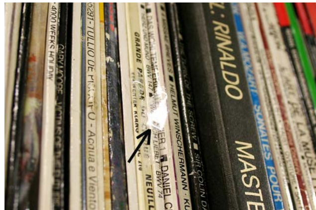
Abgelöste Folie, entstanden durch Reibung beim Herausziehen des Covers (Detail aus dem Tonarchiv von SR DRS Bern).
