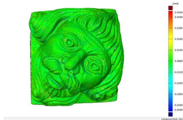
Auswertung der messtechnischen Untersuchungen mit einem Soll/Ist-Vergleich mittels der Software GOM Inspect V 7.5
