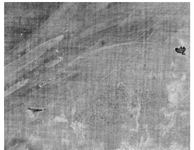
Darstellung des Details eines Wandgemäldes im Phasenbild bei Anregung mit einem Halogenscheinwerfer und einer Frequenz von 1.0 Hz. Die Malschichtlockungen heben sich hell von der unbeschädigten Umgebung ab.
