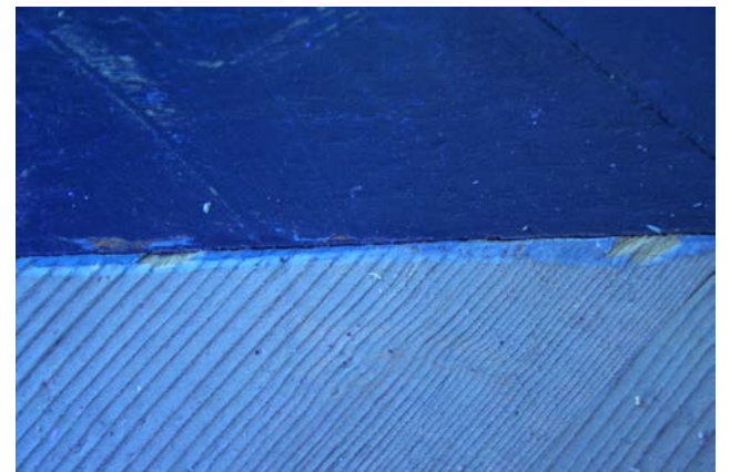
Fluoreszenzerscheinungen verschiedener Überzüge an einem Friesboden im UV-Licht
