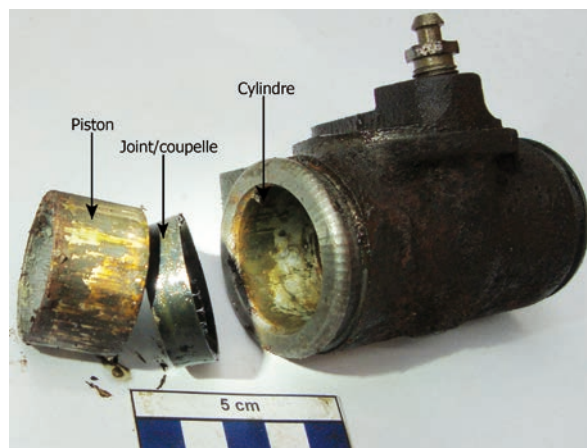
Fig. 2. Aperçu d'un cylindre de roue corrodé au niveau du piston et de l'intérieur du cylindre par le liquide de frein DOT 4 ©Fondation HAM, 2012
