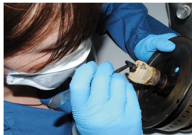
Fig. 3: Retrait d'un manchon incandescent aux oxydes de thorium qui se désagrège. Le thorium étant particulièrement un émetteur alpha (susceptible d'être ingéré), il est nécessaire de respecter les règles de radioprotection.
