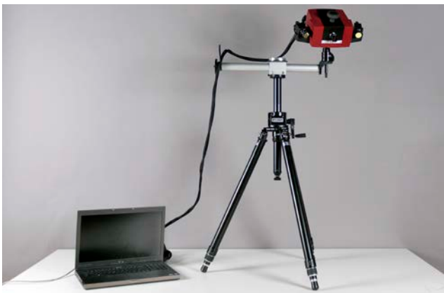
Das mobile 3D-Messsystem: ATOS COMPACTSCAN 5M
