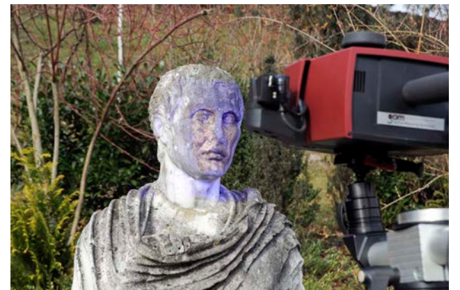
3D-Dokumentation einer Marmorskulptur mittels berührungsfreiem Messsystem im Freien
