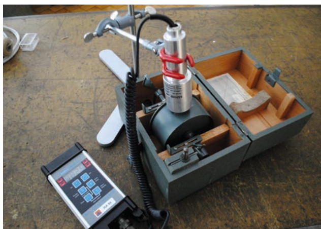
Fig. 2: Utilisation d'un radiamètre pour la mesure des coups par seconde (désintégration par seconde) d'un anémomètre (appareil mesurant la force du vent) dont l'affichage est rendu lumineux par une peinture au radium.
