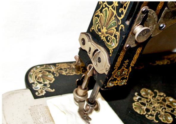
Die Abziehbild-Technik fand in der industriellen Fertigung von Massenwaren ein breites Anwendungsfeld. Insbesondere zur Ästhetisierung der Maschinenoberflächen wird diese Technik viel genutzt. In Kombination mit dem in Englisch als „black japan“ bezeichneten Einbrennlack ergibt sich eine für Maschinen aus dem 19. Jahrhundert beinahe typische Gestaltungskonvention einer schwarzen Lackierung und goldfarbigen Ornamentik.
