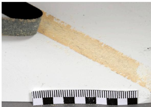
Abb. 2 „Prohibido Fumar“ 2001, Detailaufnahme, PVC-Platte 2, rechte untere Ecke: degradierte Klebstoffreste, Verschmutzungen, Delle im PVC-Träger.
