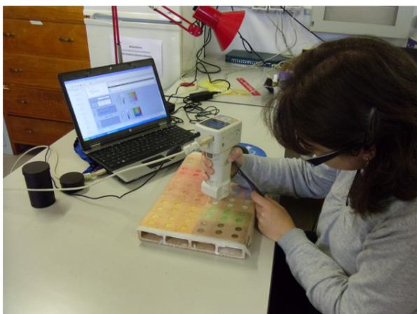
Fig. 1: Spettrofotometro Konika Minolta modello CM-700d.
