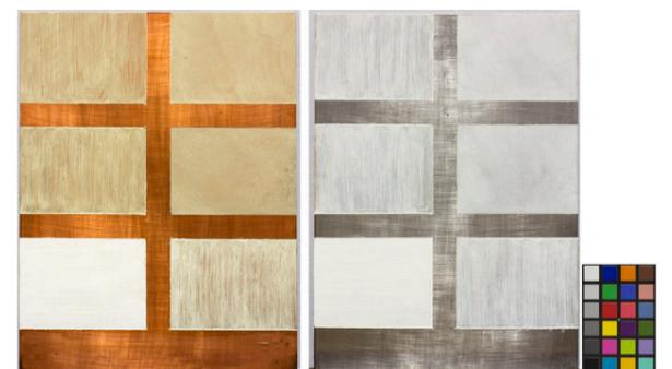
Probetafeln der Versuchsreihe V2-C (Bleiweiß in sonneneingedicktem Leinöl in verschiedenen Auftragstechniken auf Kupfer und Kupfer mit Zinn-Blei-Überzug) nach 42 Tagen Klimaalterung bei 50°C und 70% rF. Mit Ausnahme von Feld 5 (unten links: Auftrag in drei Schichten) zeigt sich eine deutliche Grünfärbung der Aufstriche auf der Kupfertafel.
