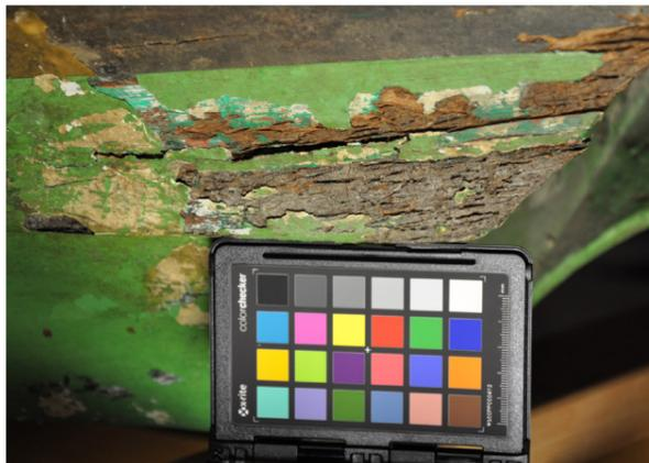
Würfelbruch an der Aussenseite des Unterwassers (Backbord, 2. Planke unten).
