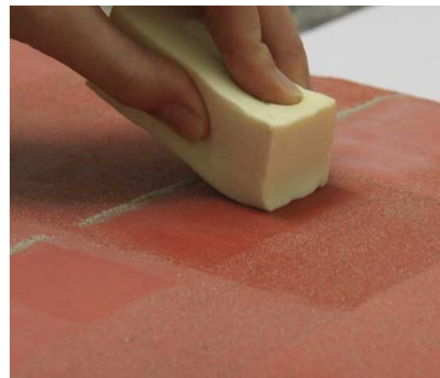
Fig. 3: Replica B. Prova di rimozione a umido con una spugna sintetica sopra la superficie trattata con 2 applicazioni di Paraloid B72.
