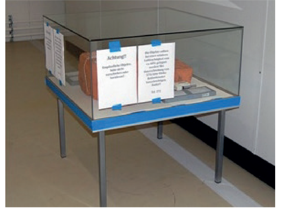
Umlagerung zweier Reliefbacksteine in eine klimatisierte Haubenvitrine, um ein feuchteres Klima zu erreichen und damit Umkristallisationen von Salzen zu verhindern.
