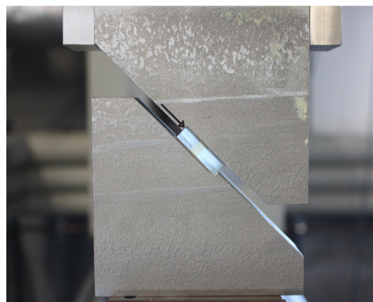
Fig. 2: Essai de cisaillement en compression (CST). L'éprouvette est placée dans l'intervalle de deux supports selon un angle de 45°. Le support supérieur, connecté à une cellule de force se déplace verticalement et applique une charge de cisaillement sur l'éprouvette. ©HECR
