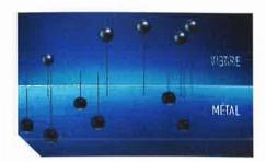
Avec la technologie ICB, l'assemblage du métal et du verre s'opère grâce à un échange d'ions entre les deux matériaux.
