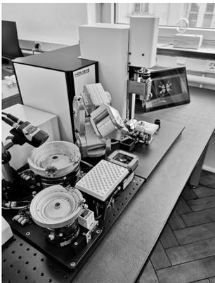
Un module d'assemblage conçu avec le bras robot Meca500
