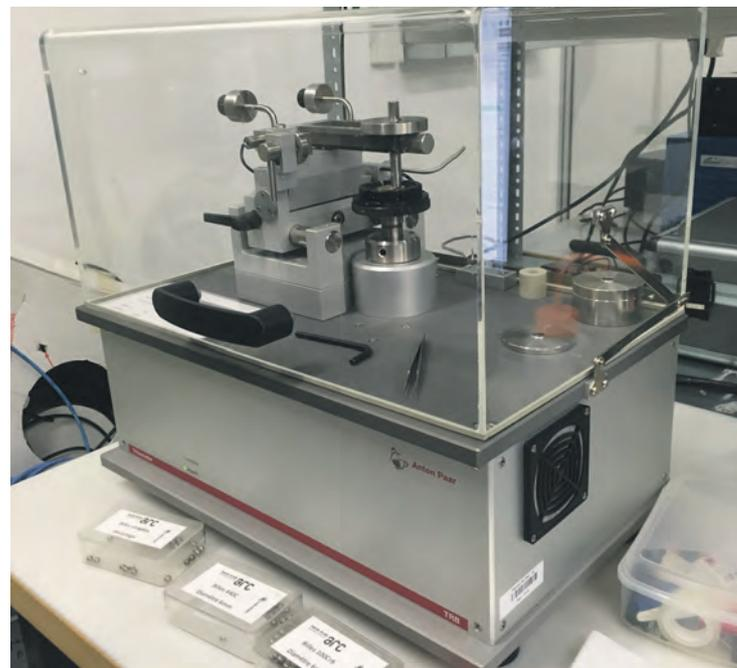
Oksana Banakh et Elie Brun mettent en place le test d'usure laboratoire pour mesurer le coefficient de frottement et l'usure d'un tribosystème.
