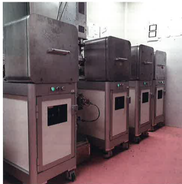
Fig. 4: Réacteur ALD conçu par l'entreprise Surcotec.
