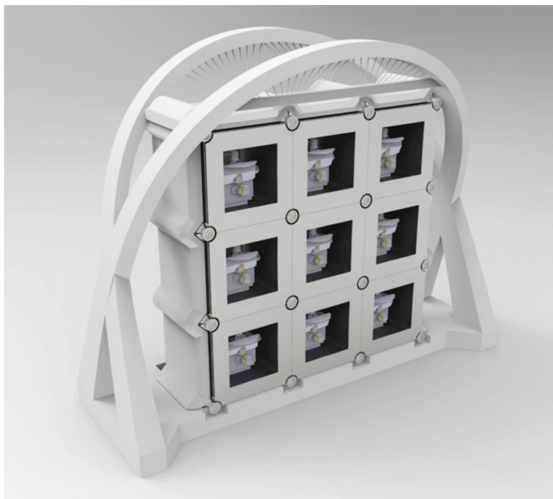
Le projet de micro-usine tel qu'imaginé par la HE-Arc Ingénierie. Chaque compartiment peut accueillir une machine de la taille de la Micro5 et les pièces à produire peuvent être transportées automatiquement d'un compartiment à l'autre. SP - HE-ARC
