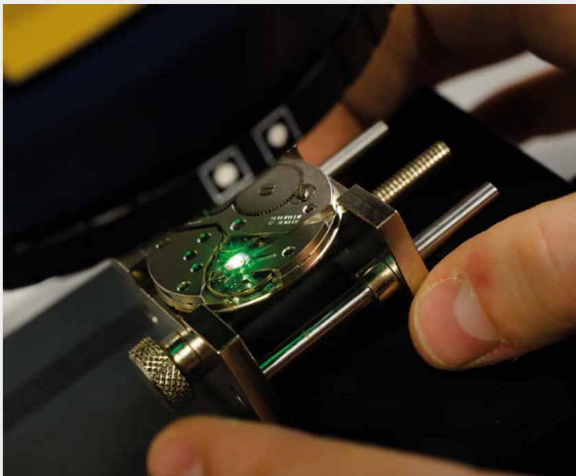
Ce vibromètre 3D permet de mesurer, par exemple, le comportement vibratoire d'un spiral. photo : patriceschreyer.com
