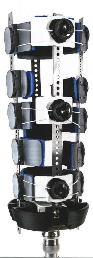
Le projet AXO a mis au point un prototype de prothèse provisoire adaptable et réutilisable, muni d'une douzaine de points d'appui réglables en hauteur, diamètre et position.
