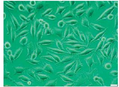
Fig. 3 - Image par microscopie optique (200x) des cellules biologiques type L929 sur la surface de l'alliage AZ31 traité MAO après 24 heures d'incubation.
