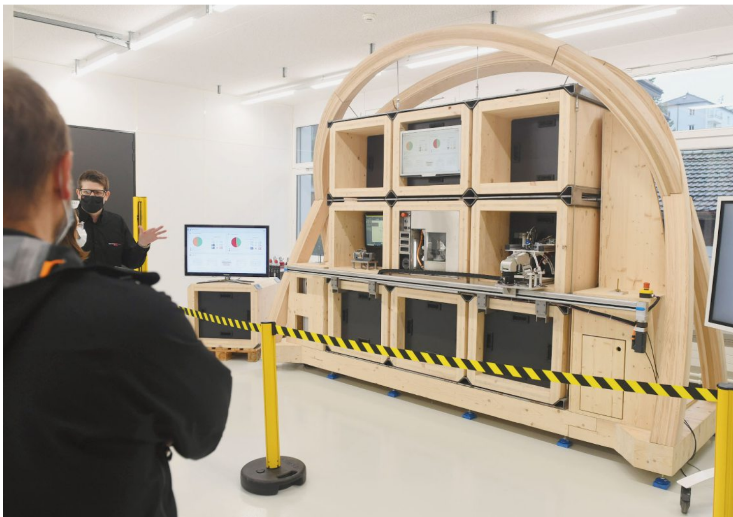
La structure de bois du MicroLean Lab permet d'absorber les vibrations des machines lors de l'usinage, et ainsi d'éviter des interférences.
