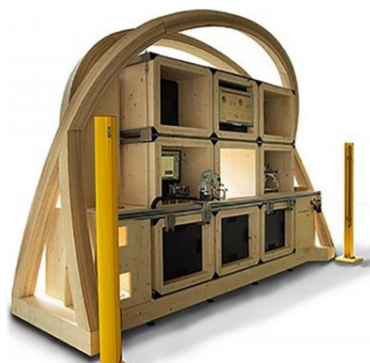
Le prototype de la micro-usine est réalisé en bois suisse – un matériau renouvelable, qui absorbe parfaitement les vibrations.
